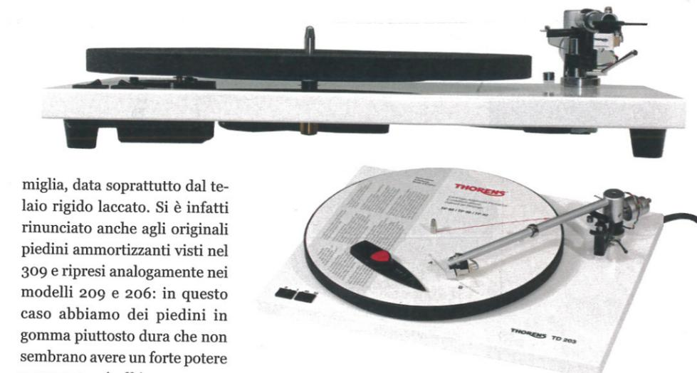
Thorens fornisce una dima della grandezza di un disco da appoggiare sul piatto con stampati gli angoli e i punti di riferimento per il migliore allineamento possibile. Queste regolazioni sono già effettuate dal costruttore e bisogna solo regolare il peso di lettura, l'antiskating ed eventualmente l'azimuth.
