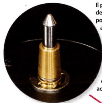
La puleggia in ottone ha una forma a botte autocentrante che tiene la cinghia di trascinamento in posizione. Il supporto del motore è un disco in acciaio fissato allo chassis con il motore disaccoppiato con tre giunti elastici in gomma.
