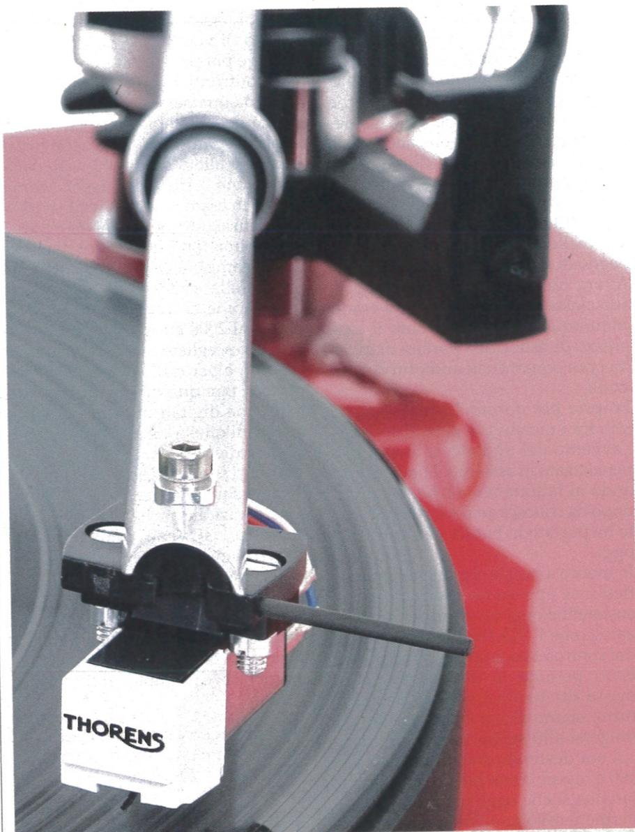
Il braccio impiega un doppio contrappeso. Quello di dimensioni minori è di tipo eccentrico, atto alla regolazione dell'azimuth, ovvero del parallelismo del portatestina rispetto al piano del disco
