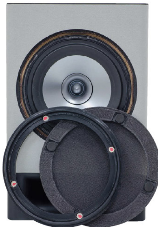
Tolta la ghiera intorno all'altoparlante si nota che non è trattenuto da viti, che infatti sono interne al mobile. Sul retro della ghiera sono invece presenti i magneti per il fissaggio della tela di protezione, amovibile.
