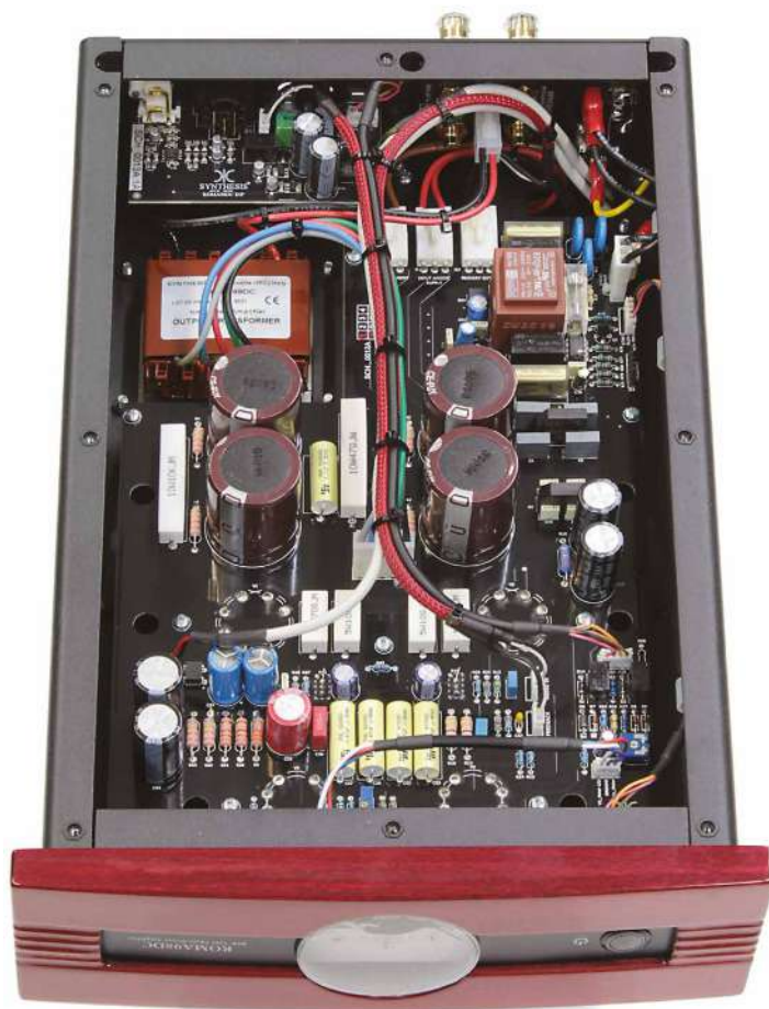
Lo stadio di potenza impiega una coppia di KT88 in push-pull e configurazione ultra lineare, che forniscono la potenza di 80 W su 6 Ohm, più lo stadio di ingresso a doppio triodo 12AY7 e il driver 6CG7. Il trasformatore di uscita è realizzato direttamente in casa con uscita singola anche se sono disponibili due morsetti di potenza per facilitare le connessioni in bi-wiring.
