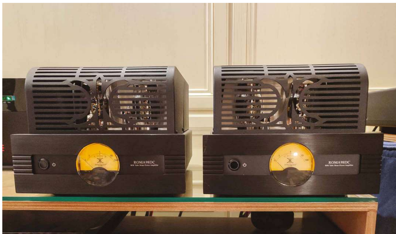
Due ingressi linea sbilanciati (RCA) uno diretto l'altro filtrato per il finale, oltre a un ingresso bilanciato (XRL). Un potenziometro regola il guadagno dei finali, operazione effettuata in fabbrica; da evitare eventuali manipolazioni salvo volerli adattare a preamplificatori di altre marche. Un commutatore consente il passaggio da bilanciato a sbilanciato mentre i morsetti per i diffusori accettano il collegamento sia a forcella che a banana.
