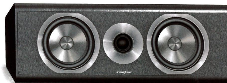
Il diffusore per canale centrale Principia C è l'unico in configurazione a sospensione pneumatica (tutti gli altri sono bass-reflex). Il C è equipaggiato con un woofer da 150 mm in polipropilene, un woofer passivo di pari diametro e un tweeter DKM da 29 mm.
