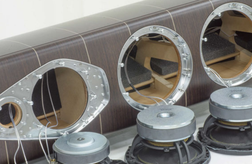
Vista ravvicinata dell'interno del mobile e degli altoparlanti. Notare il foro di decompressione ben svasato dei woofer ed il cestello aerodinamico.
