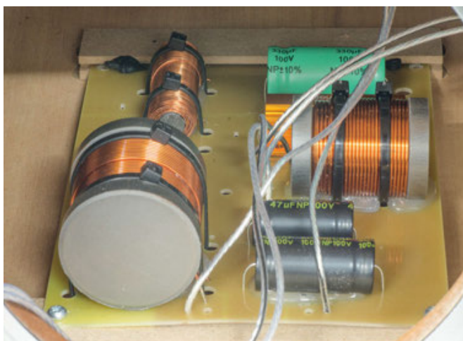
La scheda del filtro crossover dei woofer ha le induttanze di valore elevato avvolte su rocchetto di polveri di ferro. Notare gli elettrolitici bipolarizzati, usati con valori elevati.
