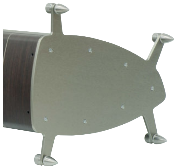
La piastra inferiore di alluminio è fresata dal pieno ed ospita quattro punte regolabili in acciaio che consentono una leggera inclinazione all'indietro del diffusore.
