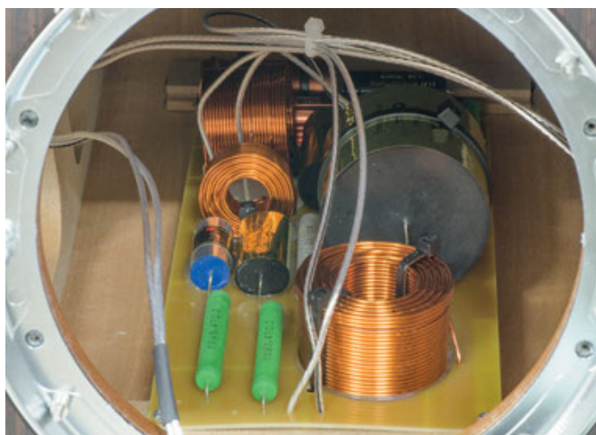
All'interno del volume di lavoro è posizionata una delle schede del filtro crossover. Notate le induttanze di valore minore avvolte in aria con le spire cementate.
