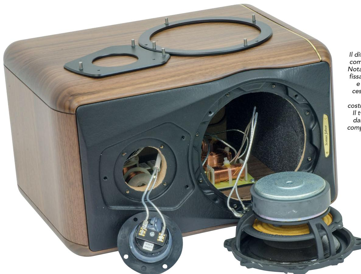
*Il diffusore con i due componenti rimossi. Notate gli otto fori di fissaggio del woofer e l'eleganza del cestello, realizzato dallo stesso costruttore vicentino. Il tweeter tradisce dalle dimensioni il complesso magnetico in neodimio.*
