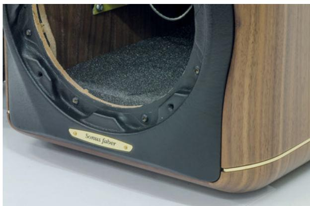
L'assorbente interno è costituito da un poliuretano abbastanza rigido ma a media densità. Notare le fessure che "incastrano" il woofer nel pannello frontale e la copertura del baffle in pelle.
