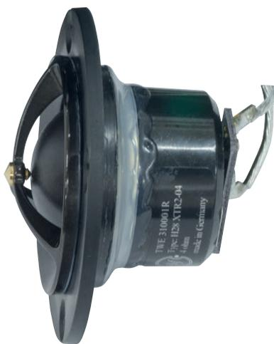
Dotato di una cupola morbida di 28 mm e di un complesso magnetico con anello al neodimio, il tweeter si fa notare per l'originale rifasatore a punta che sembra toccare la cupola proprio al suo apice, ove ad altissima frequenza possono generarsi piccole colorazioni e cancellazioni di fase.
