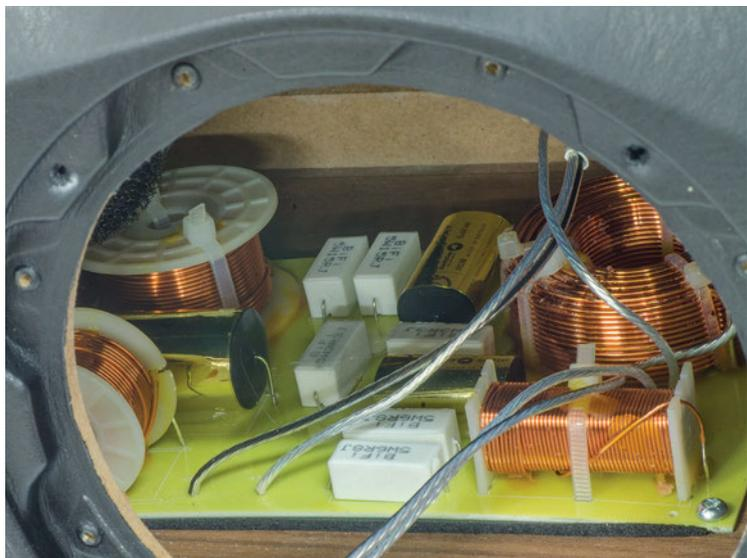
Una volta rimosso il woofer possiamo notare il supporto in vetronite del filtro crossover. Le induttanze sono avvolte in aria mentre i condensatori sono di medio livello costruttivo.
