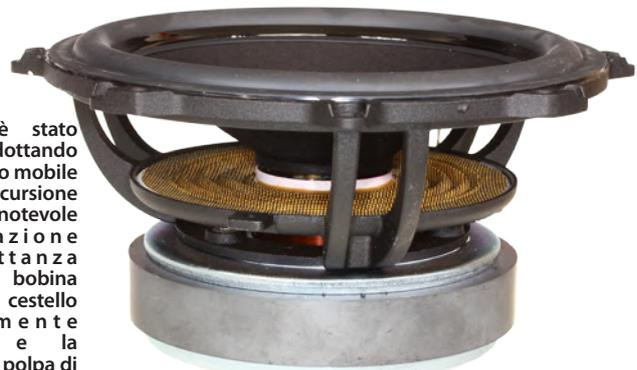
Il woofer è stato disegnato adottando un equipaggio mobile a lunga escursione con una notevole compensazione dell'induttanza parassita. La bobina è a vista, il cestello estremamente trasparente e la membrana in polpa di cellulosa.
