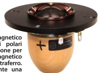
Il tweeter adotta un gruppo magnetico al neodimio con le espansioni polari tornite e lavorate con gran precisione per la costituzione di un campo magnetico omogeneo anche al di fuori del traferro. Assente il ferrofluido ma presente una ampia camera di decompressione e materiale smorzante, sia dietro la cupola che dentro il condotto.
