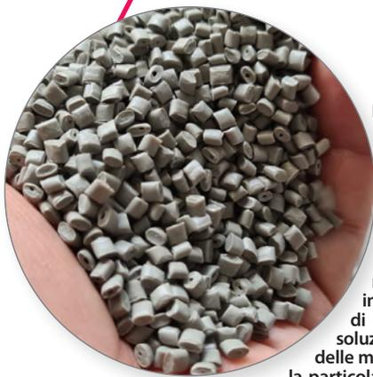
La parte inferiore del mobile non contribuisce al volume di carico del woofer in quanto separata da un setto posto in verticale e riempita con materiale plastico inerte addizionato di microsferi cave. La soluzione sposta il centro delle masse verso il basso e la particolare forma dei pellet favorisce la trasformazione delle vibrazioni, grazie all'interazione dei granelli di materiale.
