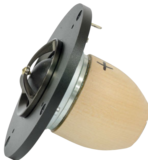
Il tweeter, a cupola morbida da 28 mm, presenta diverse finzze costruttive, a cominciare dal rifasatore a punta che carica soltanto l'apice della cupola, il complesso magnetico in neodimio e la camera posteriore di decompressione costituita da una linea di trasmissione chiusa e scavata nel legno.
