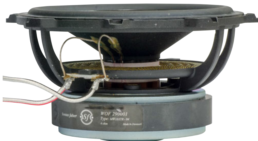
Il midwoofer è assemblato in Danimarca ma è su un cestello in pressofusione di alluminio disegnato dalla stessa Sonus faber. La bobina mobile ha il diametro di 38 mm e la membrana è in polpa di cellulosa e fibre naturali. Notate l'eleganza e l'aerodinamicità del cestello, dotato di prese d'aria anche al di sotto del centratore.
