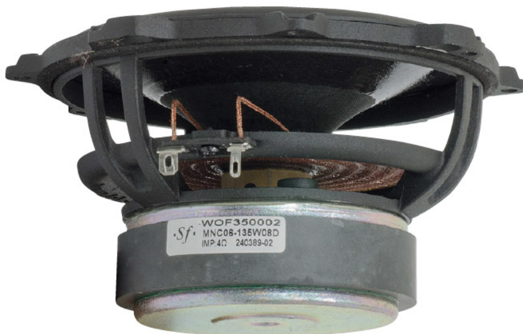
Il midwoofer WOF350002 è un ottimo componente con una struttura curata nei minimi dettagli. Notare il trattamento smorzante applicato sul lato posteriore della membrana.
