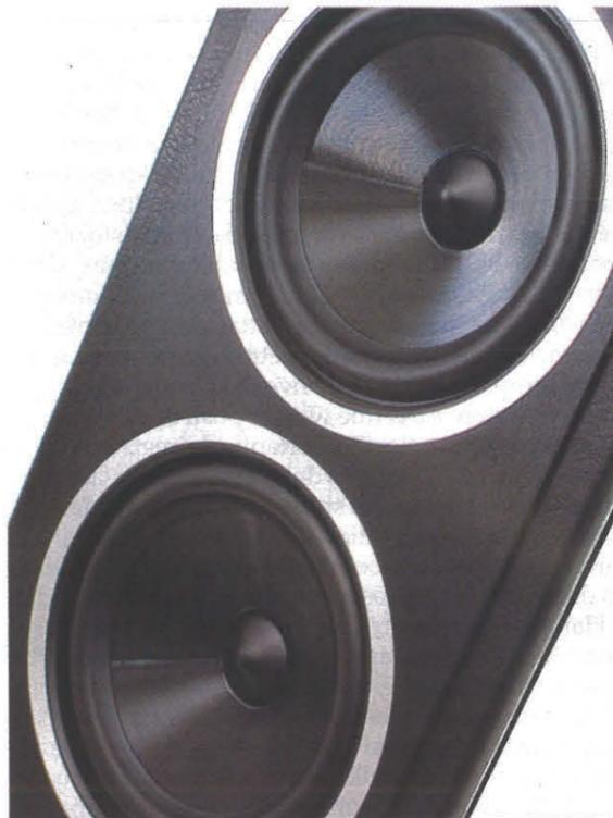
I due woofer con diametro 180 mm e driver con cono in polipropilene termoformato e cestello a compressione libera, da notare il doppio anello di ferrite (quello posteriore di dimensione ridotta rispetto a quello anteriore)
