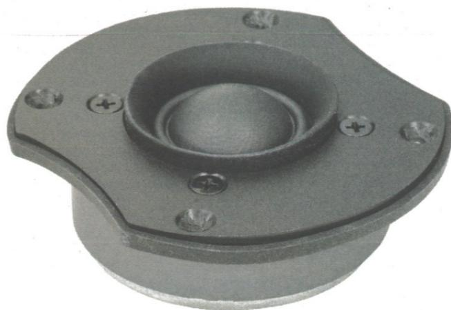
Il tweeter ha la cupola da 29 millimetri senza alcun ferrofluido nel traferro. Notare la flangia frontale che copre l'isolante in gomma che consente un vero disaccoppiamento del trasduttore dal box.
