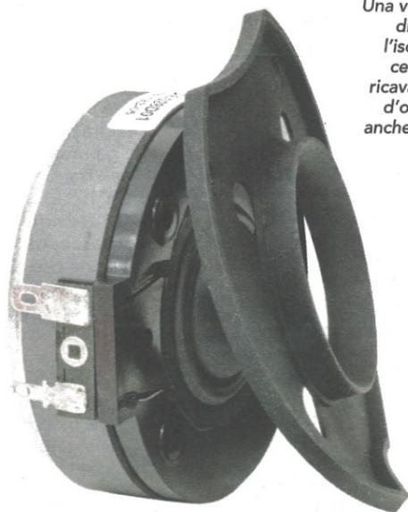
Una volta rimossa la flangia di fissaggio si vede l'isolatore in materiale cedevole nel quale è ricavata una piccola guida d'onda che condiziona anche il progetto della rete crossover.
