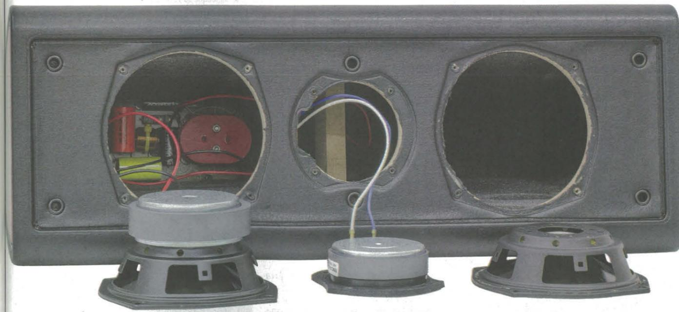
I componenti rimossi dal pannello frontale ricoperto in pelle. Notare il cestello del midwoofer e del passivo in lamiera stampata, il rinforzo dietro il tweeter ed il filtro crossover alle spalle del midwoofer attivo.
