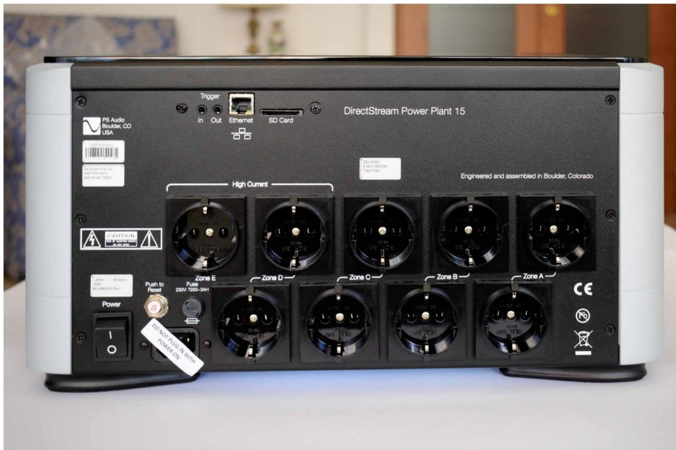
costante di energia che non è influenzata dalle richieste di picchi di potenza da parte dell'apparecchiatura collegata. Una ulteriore funzione di questi apparecchi è quella che avvia delicatamente anche grandi amplificatori di potenza e aiuta a prolungare la vita delle apparecchiature collegate a causa delle grandi correnti di spunto necessarie per riempire i condensatori di alimentazione che a riposo sono vuoti.
