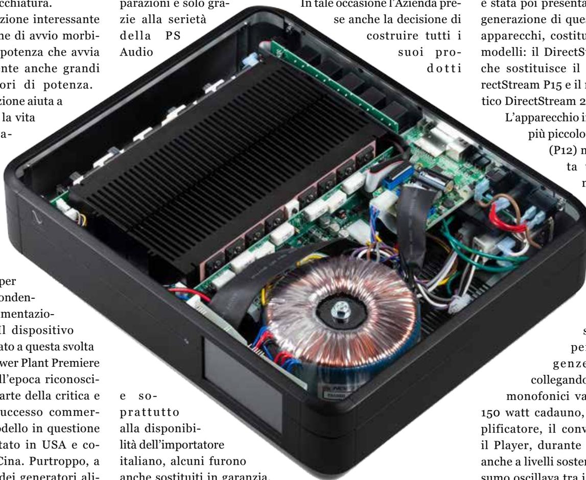
Visionando l'interno sembra di essere al cospetto di un costoso integrato che mette in mostra una batteria di 16 transistor di potenza, un possente trasformatore e due blocchi di alette di raffreddamento degni di un costoso amplificatore da 100-150 watt.
