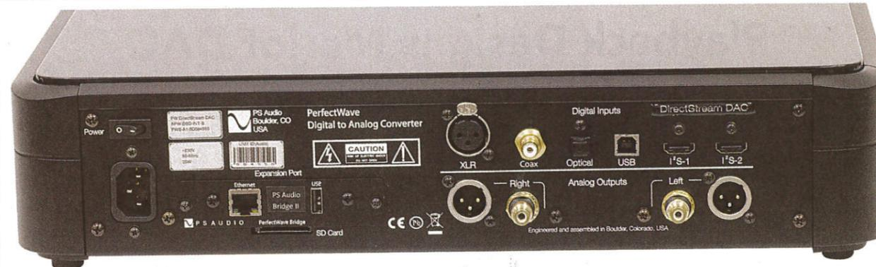
Vista del pannello posteriore con la scheda Bridge II montata.
