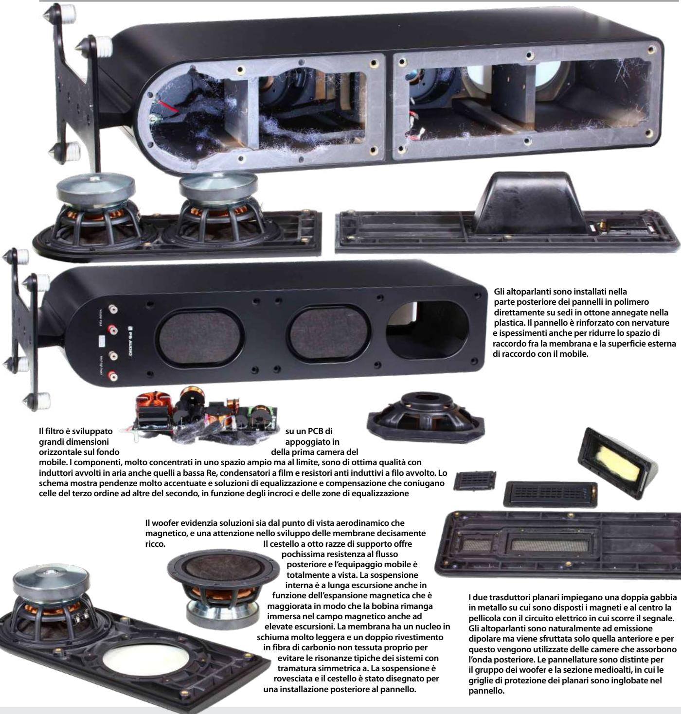
Gli altoparlanti sono installati nella parte posteriore dei pannelli in polimero direttamente su sedi in ottone annegate nella plastica. Il pannello è rinforzato con nervature e ispessimenti anche per ridurre lo spazio di raccordo fra la membrana e la superficie esterna di raccordo con il mobile.
