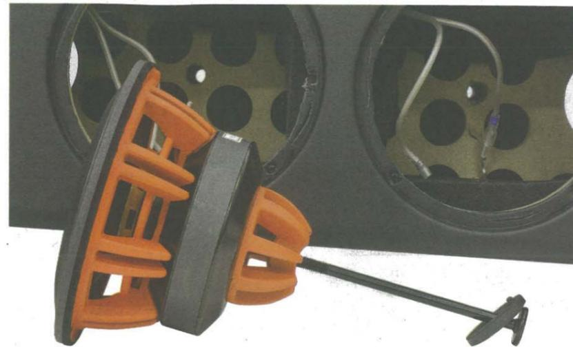
Uno dei due woofer utilizzati. Notate l'ampiezza delle finestre di aerazione dalle quali si intravede il supporto di nylon tra la membrana concava e il supporto della bobina mobile. Possiamo vedere anche il lungo asse avvitato alla struttura arancione fissata sul fondello dell'altoparlante, con aperture per il foro posteriore di aerazione.
