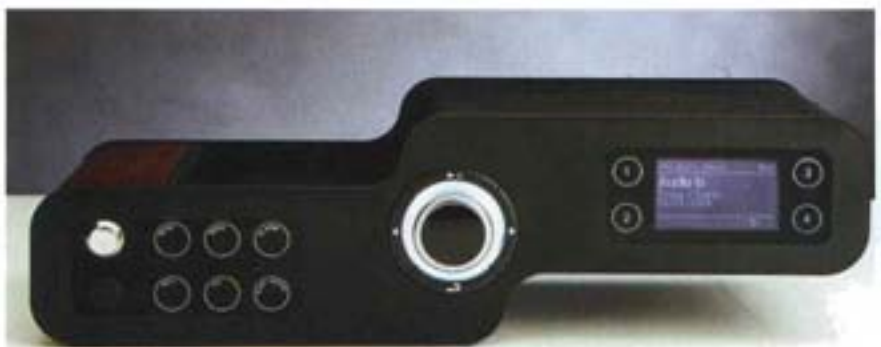
Da questo punto di vista si possono apprezzare l'inusuale geometria e la raffinatezza delle finiture: sulla destra del pannello sono alloggiati sei dei pulsanti di controllo e comando, gli altri quattro essendo integrati nel joystick che fa capo alla manopola del volume. Gli ultimi quattro, accanto al display, sono utilizzati per la preselezione delle emittenti.
