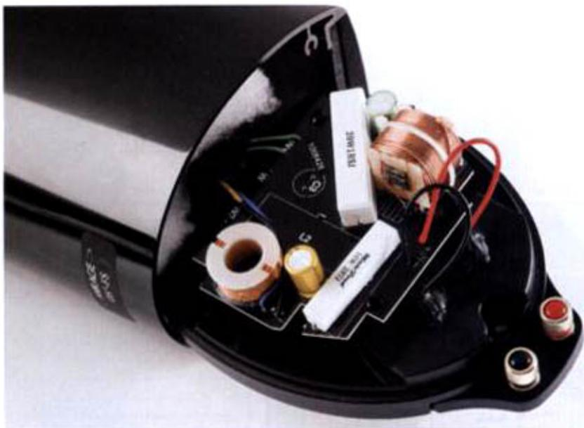
*Il filtro crossover per i midwoofer e per il midrange è sistemato alla base del diffusore. Si notano, totalmente separate, le due celle passa-basso calcolate per due frequenze differenti.*
