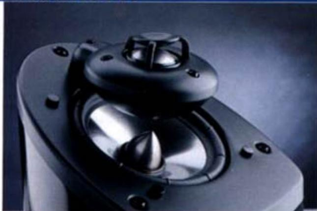
L'emissione omnidirezionale del midrange e del tweeter è controllata tramite l'inclinazione del trasduttore delle frequenze medie e dal grosso rifasatore che ospita il tweeter al suo interno. L'emissione di quest'ultimo è controllata dal piccolo rifasatore la cui forma sembrerebbe identica a quella della cupola di titanio.
