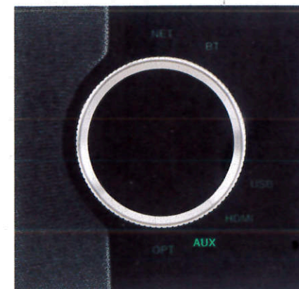
La manopola per la selezione degli ingressi (ad ogni sorgente corrisponde l'attivazione del corrispondente LED).
