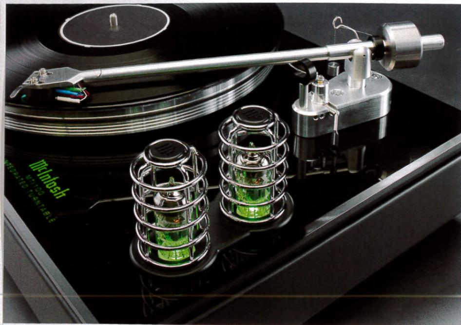
La coppia di 12AX7 utilizzate nella sezione di preamplificazione, con tanto di luce scenografica e griglia metallica di protezione altrettanto evidente quanto utile.
