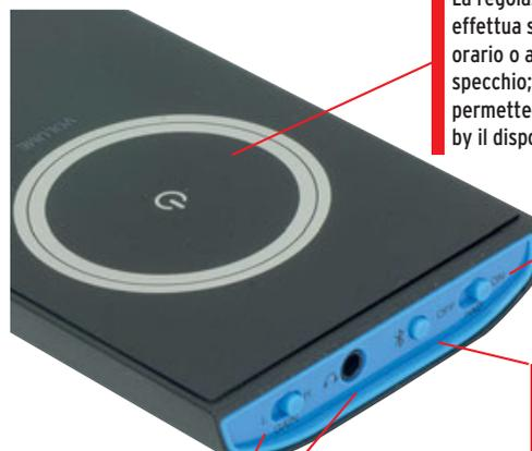
La regolazione del volume si effettua sfiorando in senso orario o antiorario il cerchio a specchio; il tasto al centro permette di mettere in stand-by il dispositivo.
