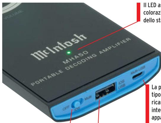
Il LED assume diverse colorazioni a seconda dello stato.
