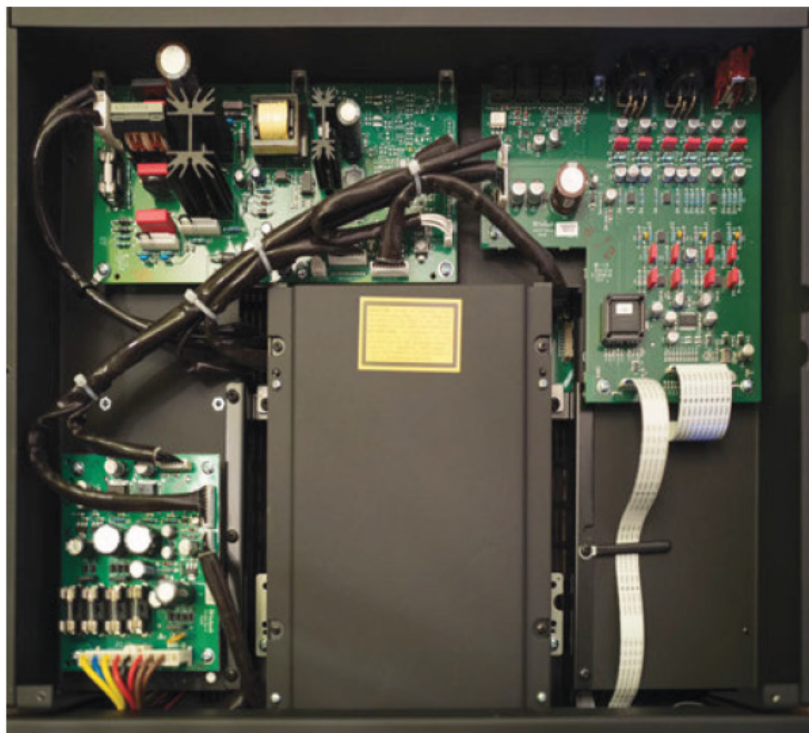
Meccanica blindata al centro, circondata dalle schede di alimentazione, dello stadio di uscita e della logica.
