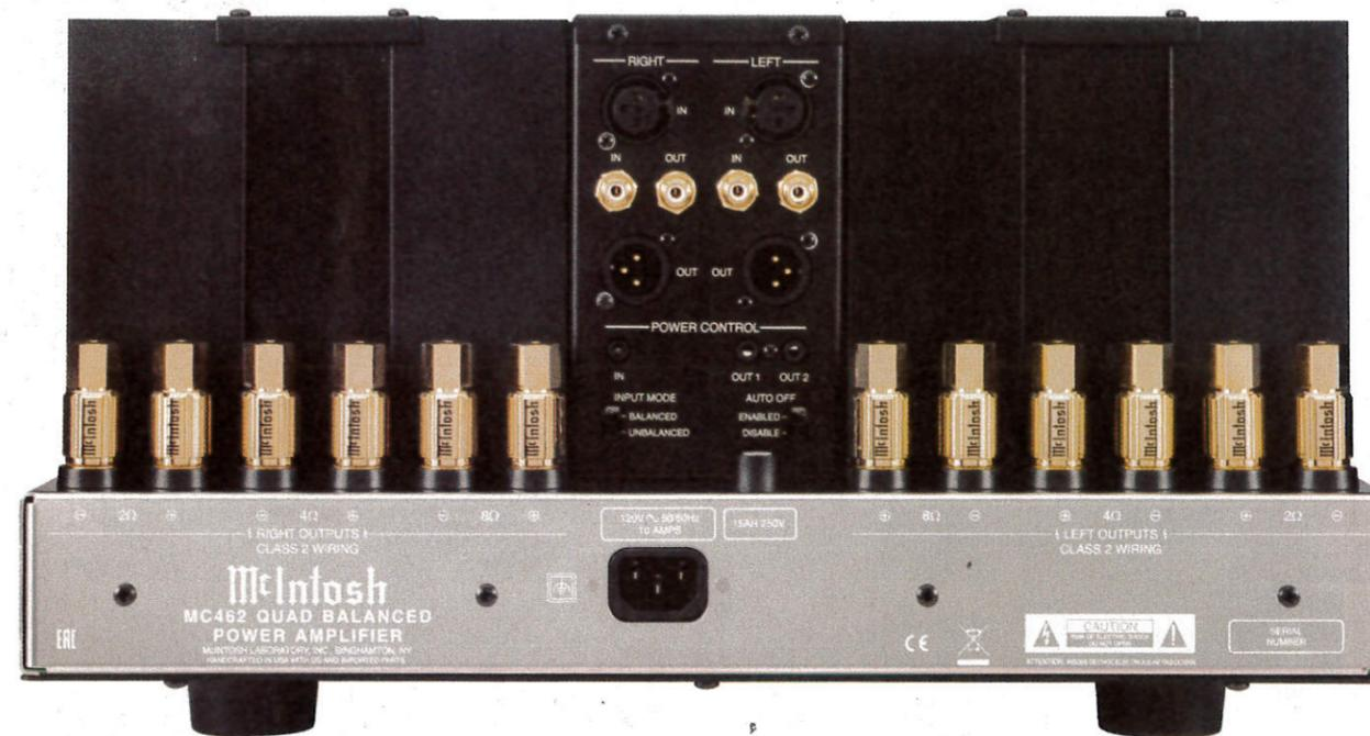
L'ampia gamma di collegamenti posteriori, da notare i binding post, introdotti a suo tempo con gli ultimi Anniversary Edition apparsi sulle pagine della nostra rivista; i serraggi a doppia vite da ammorzare mediante una chiave fornita a corredo, evitano che si possano allentare causando dannosi cortocircuiti; la batteria di ingressi/uscite bilanciati e sbilanciati offrono possibilità di triamping.
