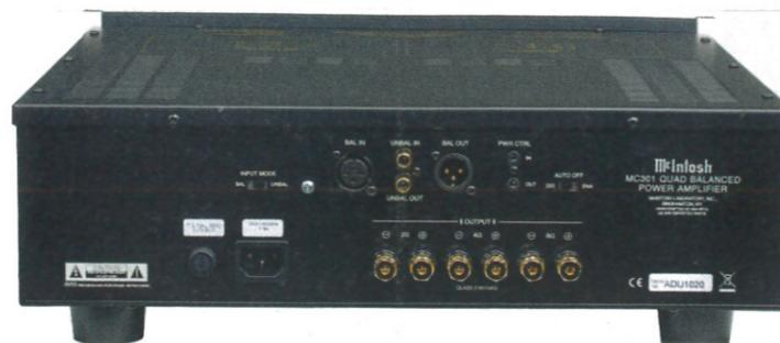
È possibile collegare il segnale in bilanciato o sbilanciato scegliendo il tipo di ingresso con il selettore a fianco dei connettori. Sono presenti anche due uscite passanti, XLR e RCA, per facilitare il collegamento con altri amplificatori in cascata per sistemi in configurazione biampificazione passiva.
