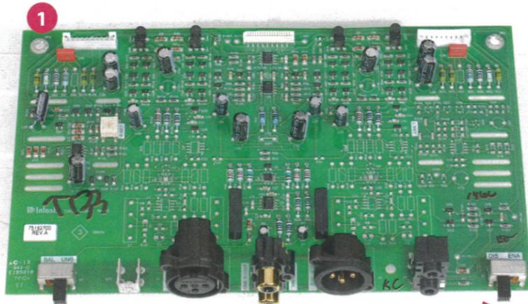
La sezione di ingresso, di controllo e di amplificazione del segnale è sviluppata su un unico PCB configurato per il trattamento di segnali monofonici sbilanciati o bilanciati. Le connessioni vengono effettuate a seconda della sezione specifica tramite flat cable a bassa corrente, connettori rapidi per arrivare a innesti di grandi dimensioni oppure concavi di grande sezione terminati con Fast on.
