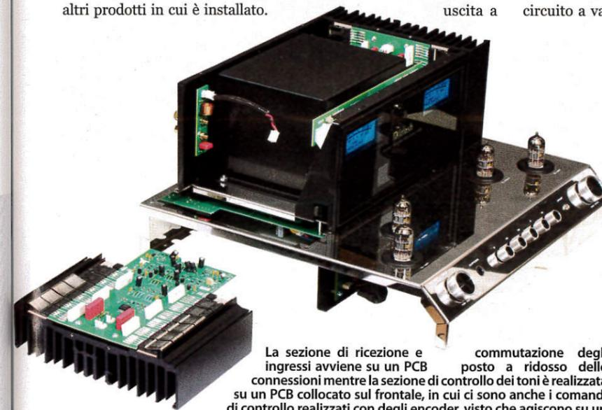
La sezione di ricezione e commutazione degli ingressi avviene su un PCB posto a ridosso delle connessioni mentre la sezione di controllo dei toni è realizzata su un PCB collocato sul frontale, in cui ci sono anche i comandi di controllo realizzati con degli encoder, visto che agiscono su un controllo del volume integrato. Lo stadio di amplificazione lineare impiega due doppi triodi un 12AT7 e un 12AX7A.
