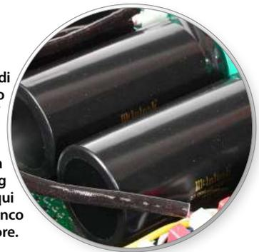
La batteria di condensatori di filtro è costituita da quattro condensatori da 27.000 uF ciascuno con tensione di lavoro da 100V installati ora in un castello nella parte superiore (vedi pag precedente) e non più qui nell'alloggiamento al fianco della base del trasformatore.
