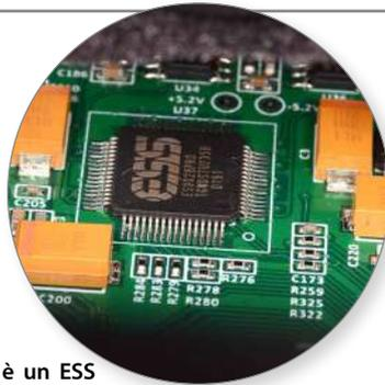
Il DAC è un ESS Sabre ES 9028Pro con otto canali in uscita è il circuito analogico IV realizzato con operazionali Texas a basso rumore e componentistica di selezionata.
