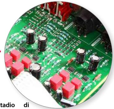
Lo stadio di preamplificazione utilizza amplificatori operazionali Texas Instruments N5534 e commutatori a relè di tipo Reed Littlefuse e Hamlin. Lo stadio phono è configurato per avere il guadagno variabile e i carichi per testine MM e MC selezionabili tramite commutatori a stato solido.
