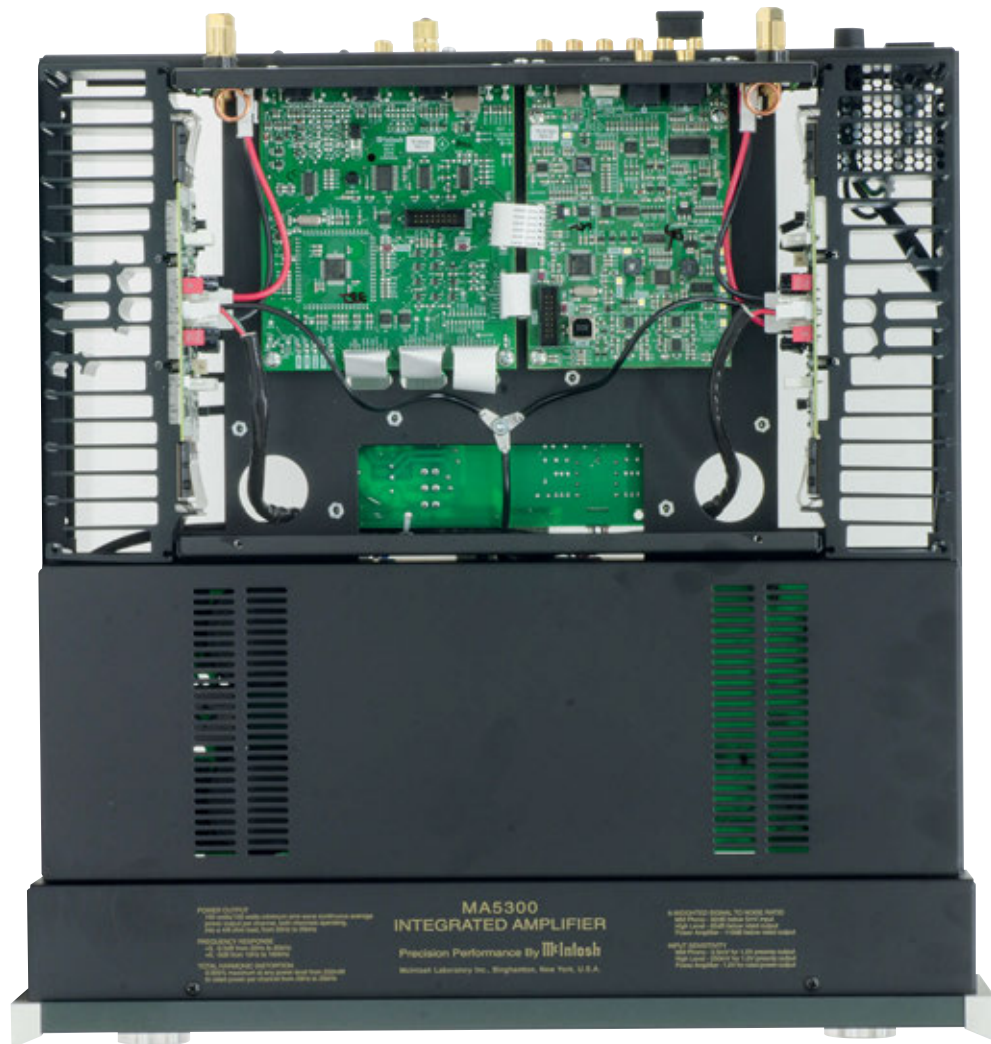
La sezione digitale è montata nel vano superiore del volume interno, e seppure non blindata è separata dalle aree analogiche - in particolare dal fono - da una parete metallica che si è dimostrata del tutto in grado di eliminare le possibili interferenze. Da notare la struttura "stellare" anche dei punti di attacco della terra di rete, che dal punto di vista elettrico in questo apparecchio è direttamente connessa con la massa di segnale.
