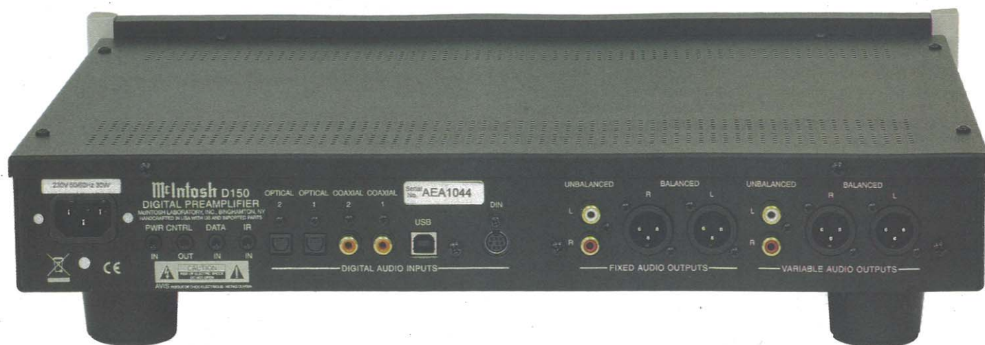
Nella parte centrale del pannello posteriore sono collocati i connettori dei sei ingressi digitali, tra cui il mini-DIN per ricevere il segnale DSD da un lettore SACD McIntosh. Sulla destra vi sono invece le uscite analogiche fisse e variabili, sia in forma bilanciata sia in forma sbilanciata.
