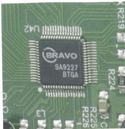
Il controller USB che acquisisce i dati dal computer in modalità asincrona è il Bravo SA9227 prodotto dalla SaviAudio.
