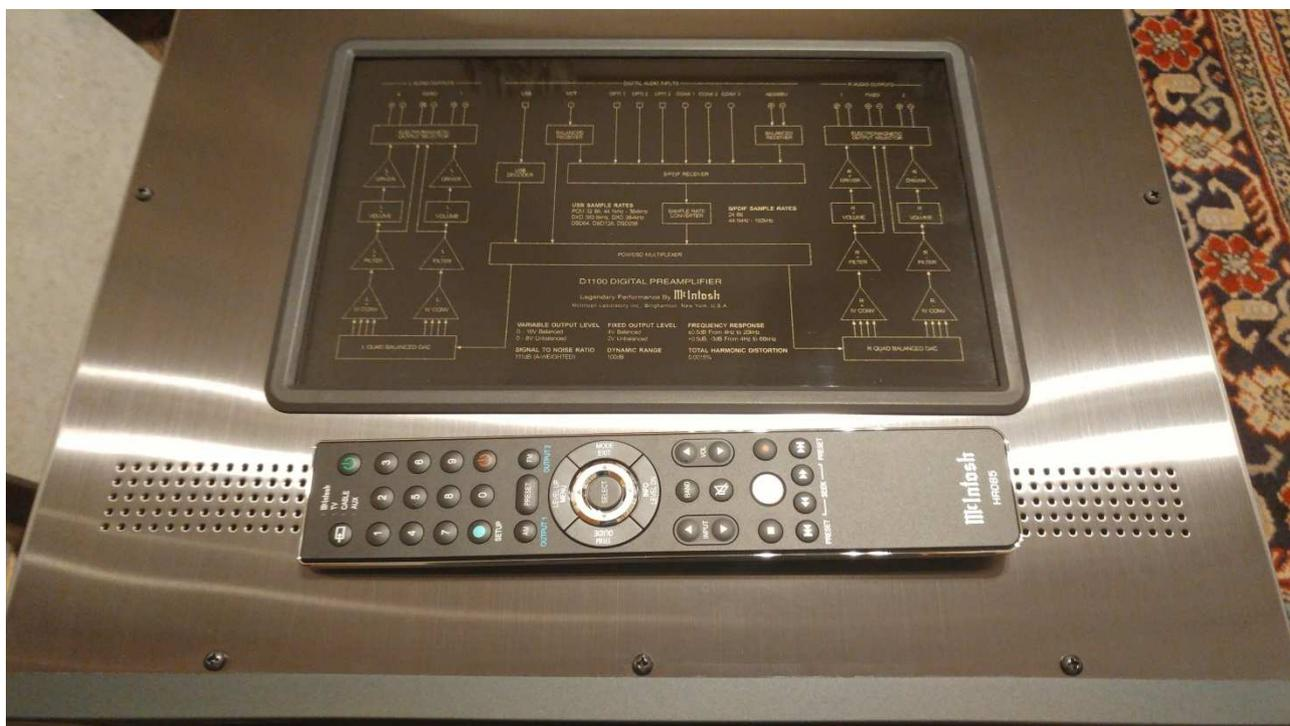
Il convertitore lavora a 32 bit su 8 canali (4 per canale) per gli ingressi USB e MCT. Lavora a 24 bit sugli altri ingressi Aes/Ebu (1), ottici (3) e coassiali (2RCA e 1BNC). La frequenza di campionamento massima per l'ingresso USB arriva fino ai 384Khz ed accetta file con risoluzione PCM fino a 384Khz - DSD64, 128 e 256 - DXD352.8 e 384Khz.
