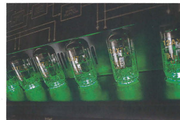
La finestra praticata sul pannello superiore per mostrare le sei valvole 12AX7 utilizzate.
