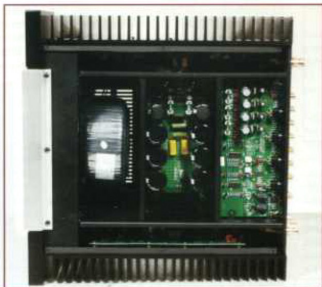
Interno giustamente affollato per un ampli di questa stazza, con fianchi dotati di ragguardevoli alettature, onde favorire il raffreddamento.
