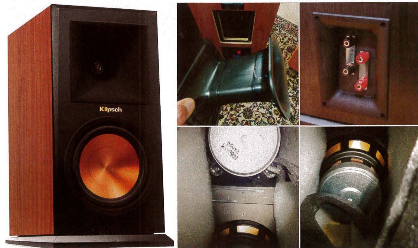
Foto 2 e 3 - Il frontale del diffusore con il caratteristico woofer cerametallico color rame e la tromba Tractrix di nuova generazione che "carica" il tweeter in titanio da 2,5 cm. Nel mosaico a destra, alcuni particolari costruttivi: l'accordo reflex bi-svasato "Tractrix", l'economica morsettiera e il materiale fonoassorbente interno, comprese le coperture dei cavi di collegamento crossover-altoparlanti.
