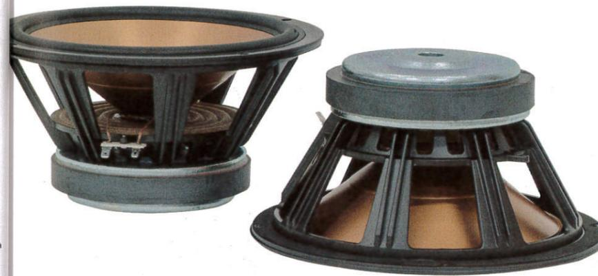
I due woofer da dieci pollici usati sono stati ridisegnati dal costruttore. La membrana è in alluminio trattato. Notare il singolo anello di sospensione in gomma, il cestello pressofuso ed antirisonante e le ampie prese d'aria al di sotto del centratore.
