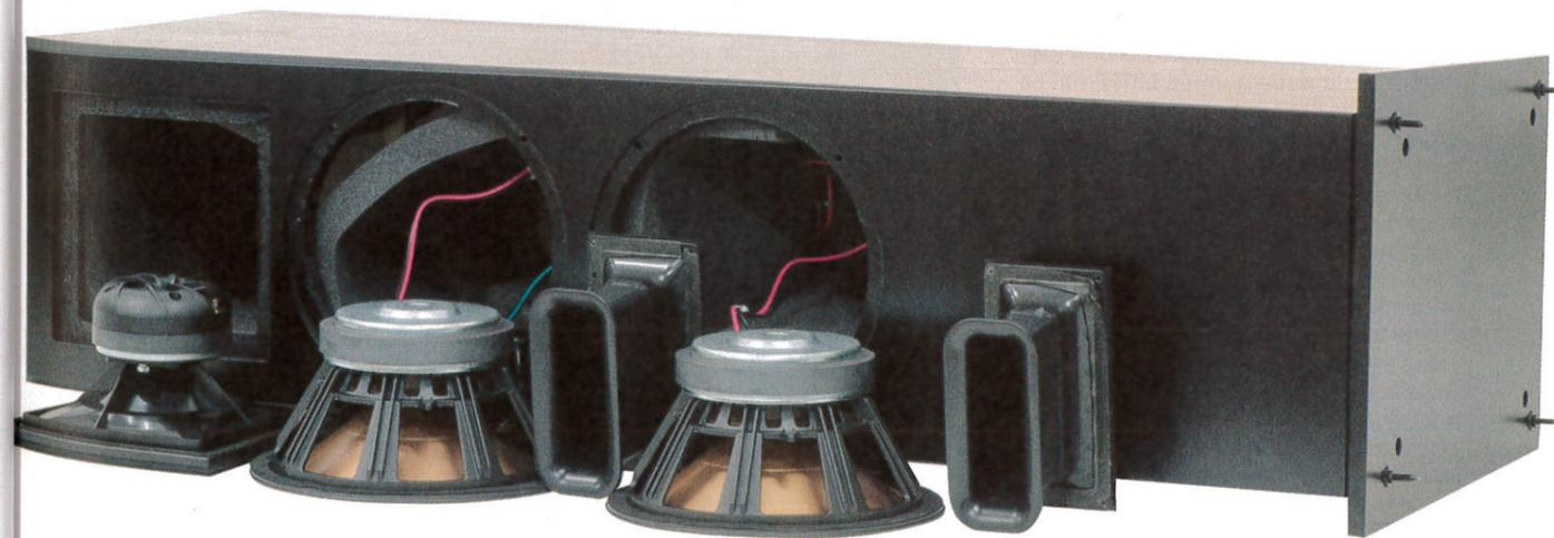
Il sistema di altoparlanti smontato nei suoi componenti, inclusi i due condotti a profilo Tractrix.
