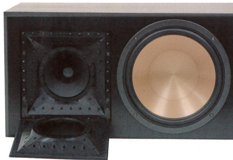
La tromba del tweeter è realizzata in gomma morbida e fissata ad incastro nella flangia sul pannello frontale. Notare lo sviluppo a tronco di cono che costituisce la forma iniziale della tromba.
