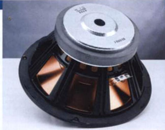
I woofer da dieci pollici sono realizzati su un cestello pressofuso ben aerato per permettere un corretto scambio di calore da parte della bobina mobile. Notare la membrana in Cerametallic dal caratteristico colore ramato ed il discreto complesso magnetico.
