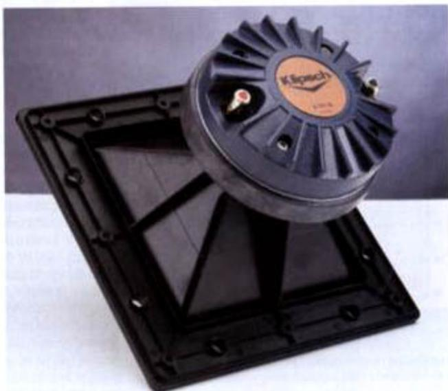
*Il tweeter ha la cupola da 44,5 millimetri di titanio caricata da una tromba a profilo Tractrix che ne eleva la già notevole sensibilità, ne estende la risposta alle medie frequenze e ne ottimizza la dispersione. Si tratta di un componente comunque molto robusto, tanto da poter essere incrociato con i woofer a soli 1200 Hz.*
