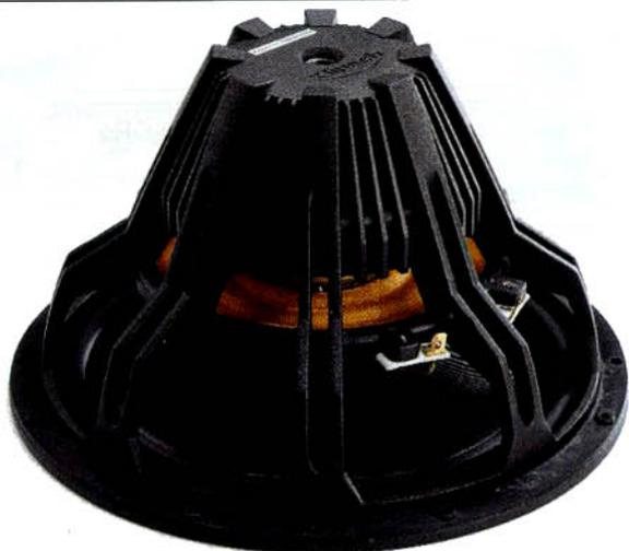
*Le tre trasduttori delle note basse sono curatissimi dal punto di vista costruttivo nel tentativo, ben riuscito, di contenere al massimo tutte le non linearità. Triplo anello magnetico in neodimio con l'aggiunta di due magneti stabilizzatori di campo, polo centrale molto più alto della piastra di campo, sospensione rovesciata e membrana in compound sono le sue caratteristiche salienti.*
