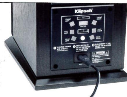
Sopra, il pannello posteriore di tutti i diffusori del sistema riporta la semplice procedura per il collegamento senza fili. A destra, il controller del sistema che contiene le connessioni, la sezione DSP e il trasmettitore wireless verso i diffusori.
