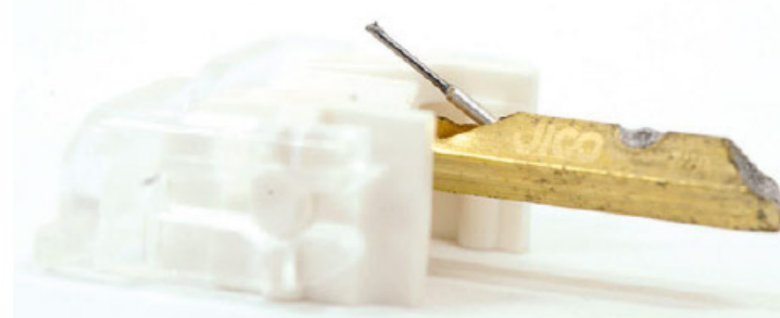
Cantilever in boro e puntina in diamante naturale con taglio laser tipo Fine-Line per lo stilo JICO N-44-7 SAS/B.
