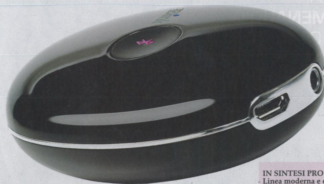
Esteticamente molto originale, il miniBlink può essere scambiato per un mouse. Da notare: il pulsante con inciso il logo Bluetooth funge anche da spia luminosa di funzionamento mentre la porta di connessione e ricarica è di tipo mini USB.
