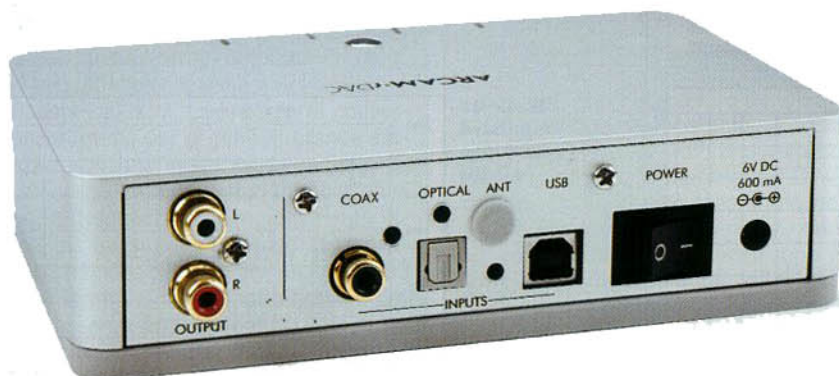
Sul piccolo pannello posteriore sono presenti tutti gli ingressi realmente necessari oggi: SPDIF elettrica ed ottica e USB in grado di accettare segnali ad alta risoluzione.
