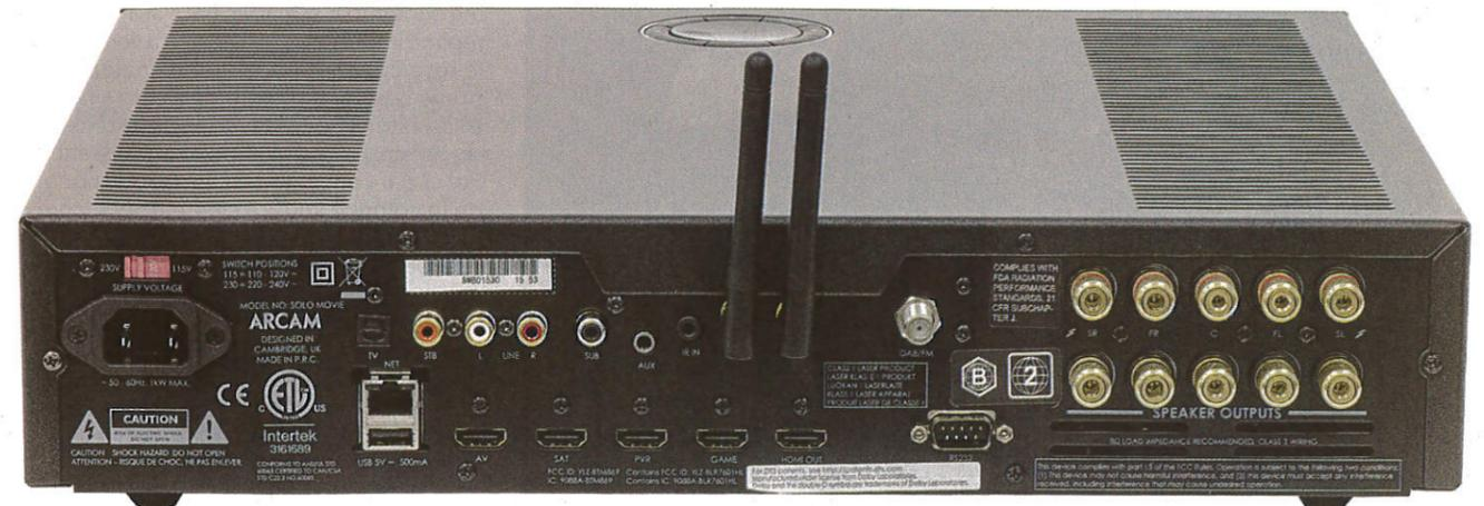
Nella parte sinistra del pannello posteriore sono visibili in basso i connettori Ethernet, USB e HDMI (4 di ingresso e 1 di uscita), in alto i connettori dei due ingressi audio digitali (coassiale e ottico) e dei due ingressi audio analogici (RCA e mini-jack). Al centro sono invece collocate le antenne per il Wi-Fi/Bluetooth e per il sintonizzatore FM/DAB. Sulla destra troviamo infine le cinque coppie di morsetti, di buon livello costruttivo, per il collegamento dei diffusori.
