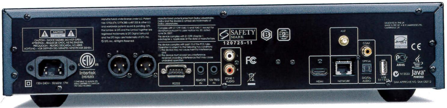
Sul pannello posteriore dell'UDP411 abbondano i connettori: notare la presa di rete di Classe II, le uscite XLR bilanciate, l'uscita HDMI, la presa per l'antenna Wi-Fi, le porte Ethernet e USB; non mancano i pre-out RCA e le uscite ottica e coassiale.
