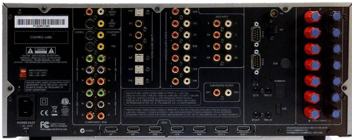
Connessioni disponibili in gran numero, anche digitali. Comoda la sezione di collegamento A/V analogica per una seconda zona ma, invece, mancano i pre-out per il collegamento di uno o più finali esterni.
