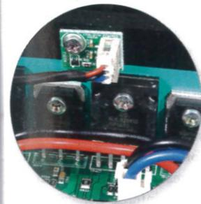
Nonostante l'utilizzo dei dispositivi di potenza dotati di Thermaltrak, sono presenti sensori di temperatura posti nelle vicinanze delle batterie di transistor.
