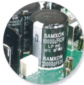
I circuiti di alimentazione sono sdoppiati in seguito alla configurazione della classe G che sfrutta due sezioni in cascata.
