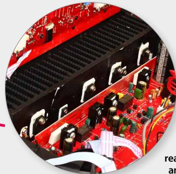
La sezione linea è realizzata con amplificatori operazionali JRC 2068 mentre quella di conversione IV successiva al DAC Burr Brown PCM 1796 impiega dei Texas NE5532. La sezione finale di potenza ha una coppia di transistor B817 e D1047 per canale installati sullo stesso dissipatore collocato in posizione centrale dell'apparecchio.
