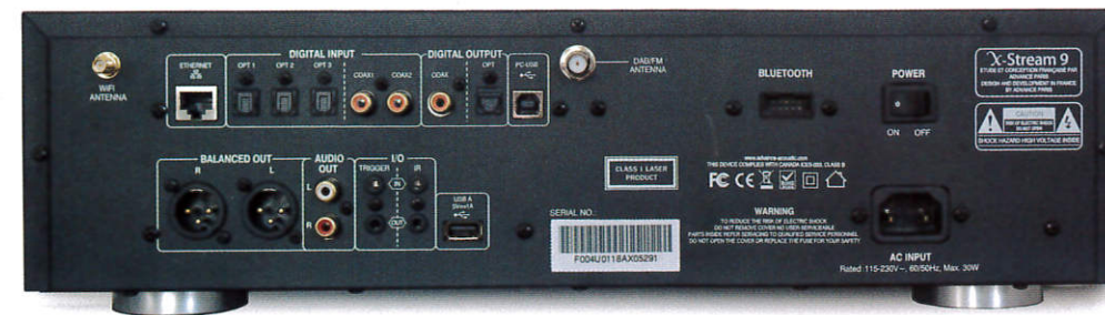
Il pannello posteriore dell'X-Stream 9: si riconoscono, tra gli altri, i cinque ingressi digitali (tre ottici, due coassiali), l'interfaccia per l'adattatore Bluetooth e le uscite linea sbilanciate e bilanciate (in basso a sinistra).
