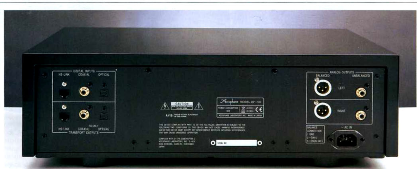
Sul pannello posteriore del DP-700 troviamo sulla sinistra gli ingressi digitali e le uscite digitali nei formati HS-Link, coassiale e ottico. Sulla destra troviamo invece le uscite analogiche di tipo sia bilanciato sia sbilanciato.
