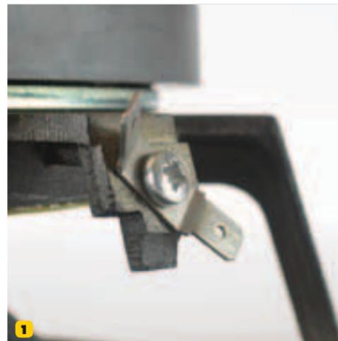
**1** Un particolare delle spine faston direttamente avvitate al cestello sul lato opposto rispetto ai terminali di collegamento del woofer. Dalla vaschetta dei connettori il cavo di terra va a collegarsi direttamente a questo terminale permettendo di schermare il cestello e proteggere dalle onde elettromagnetiche le bobine dei driver.
